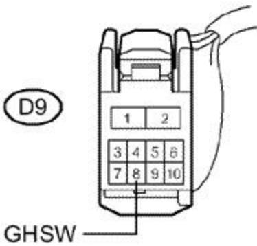
线束连接器前视图：（至开启器开关）
